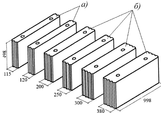
*a)* – плита перегородочная; *б)* – блок, размеры в мм
