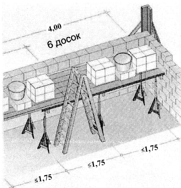
Рисунок 14 – Переставные леса, размеры в м
