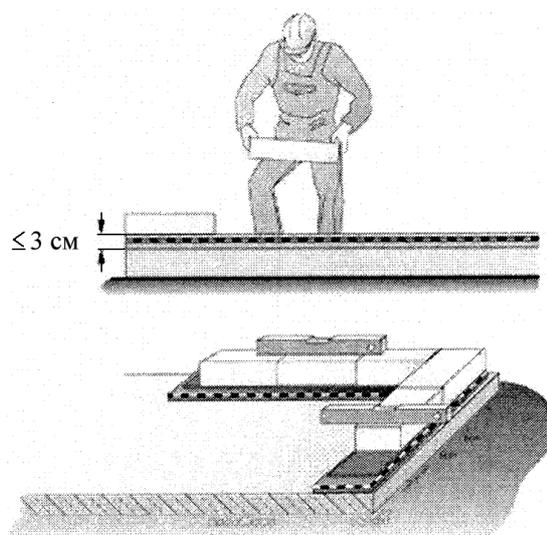
Рисунок 27 – Выполнение опорного ряда кладки
