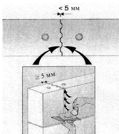
Рисунок 35 – Заполнение вертикальных швов шириной 5 мм и более
