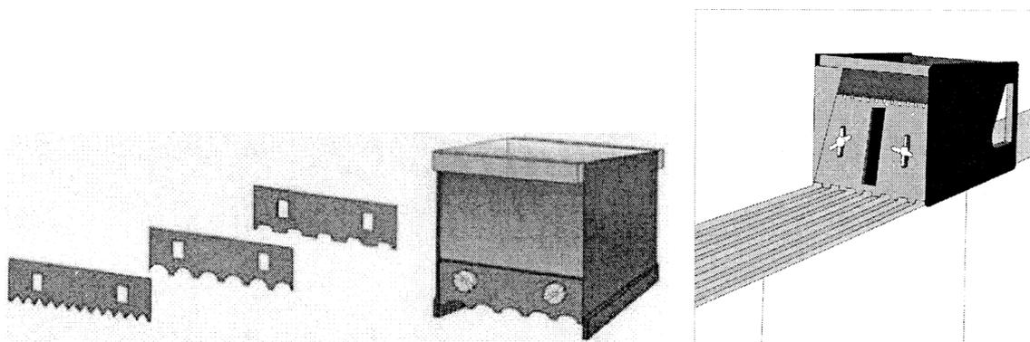
Рисунок 10 – Каретка (салазки) для раствора для тонкошовной кладки
