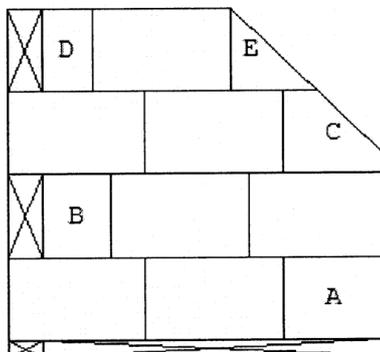
Рисунок 22 – Дополнительные компенсирующие элементы во фрагменте стены
