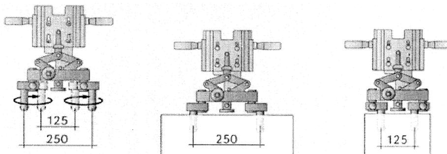
Рисунок 18 – Грейферное захватное устройство, размеры в мм
