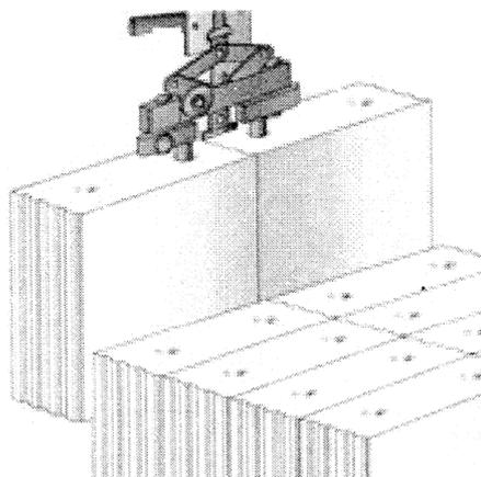
Рисунок 46 – Захват грейферным захватным устройством двух блоков
