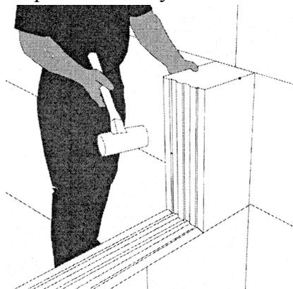
Рисунок 42 – Уплотнение раствора для тонкошовной кладки
