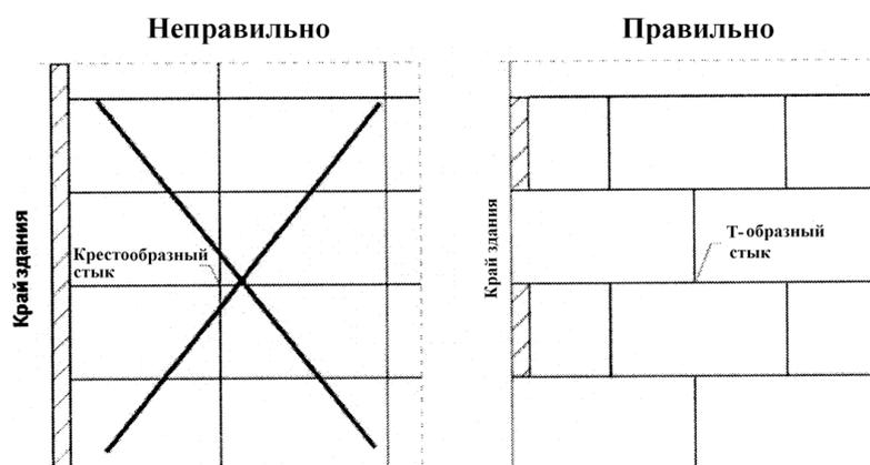
Рисунок 51 – Укладка теплоизоляционных плит с перевязкой (смещением)
