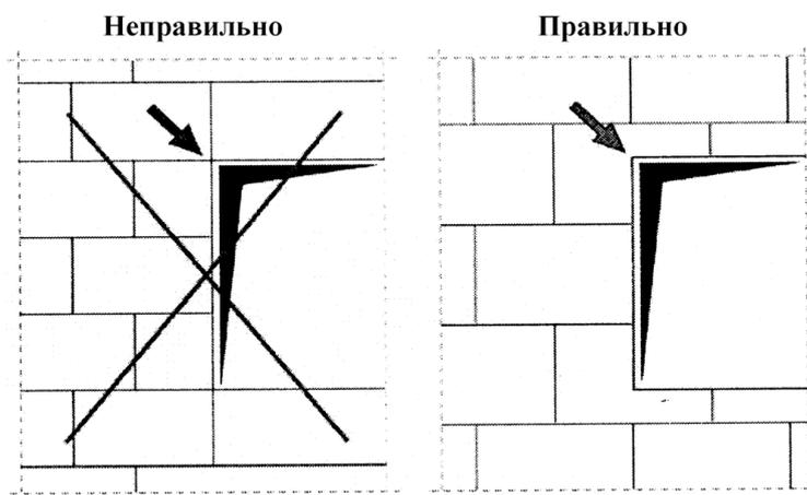
Рисунок 52 – Укладка теплоизоляционных плит по периметру проема
