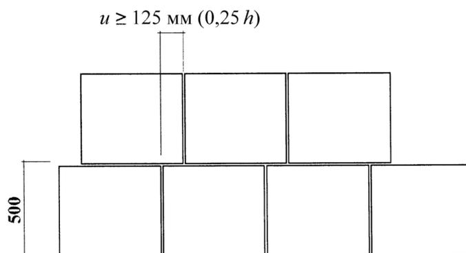
Рисунок 37 – Минимальная глубина перевязки блоков высотой 498 мм
