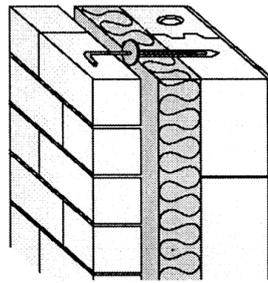
Рисунок 56 – Стержневые связи с прижимными влагоотводящими шайбами
