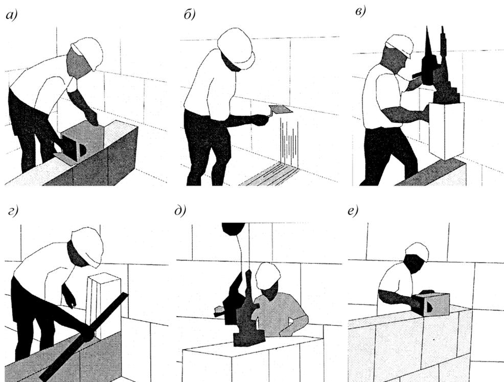
*a)* – выполнение горизонтального шва; *б)* – выполнение вертикального шва; *в)* – установка первого блока в ряду; *г)* – выравнивание установленного блока; *д)* – установка последующих блоков; *е)* – выполнение горизонтального шва следующего ряда
