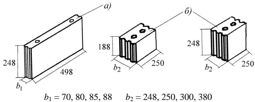
*a)* – плита перегородочная; *б)* – блок,  $b_1$  – ширина плиты перегородочной, мм;
