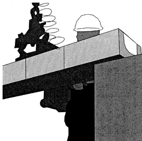
Рисунок 48 – Монтаж оконной перемычки из U-образных блоков
