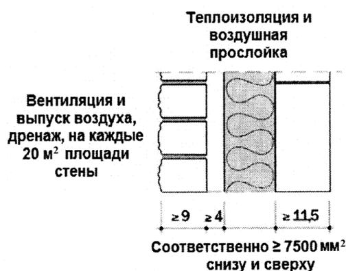
Рисунок 53 – Конструкция со слоем теплоизоляции и воздушным зазором (прослойкой)
