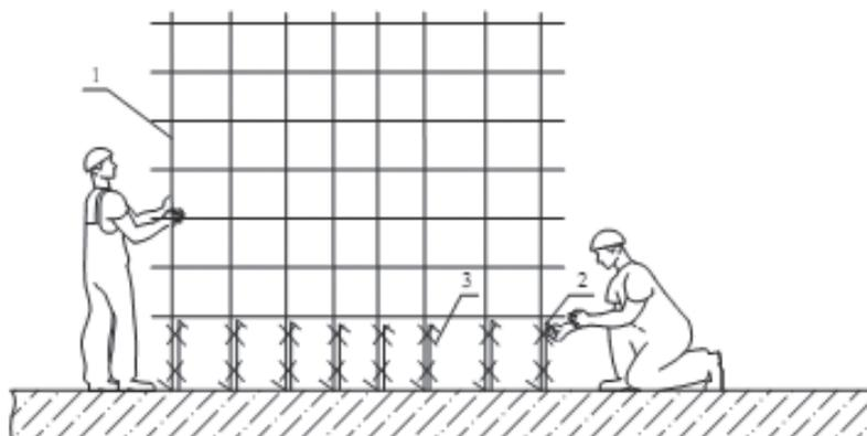
Установка поперечных арматурных стержней на высоте до 1,5 м
