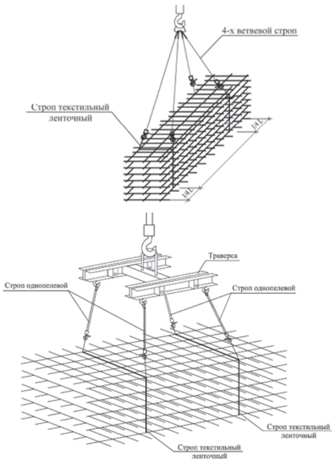
Рисунок Н.2 – Схема строповки пакета плоских сеток
