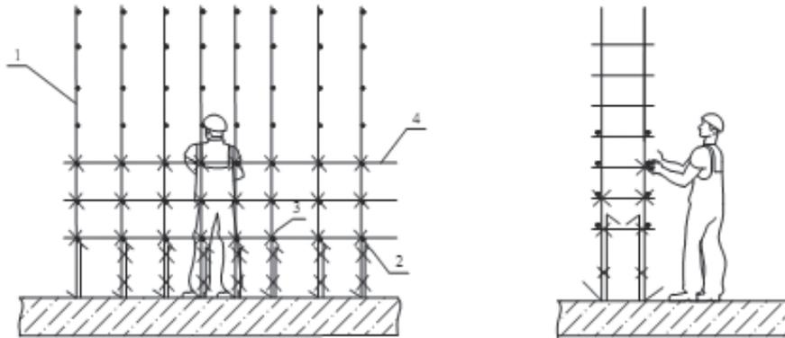
Установка продольных арматурных стержней на высоте выше 1,5 м
