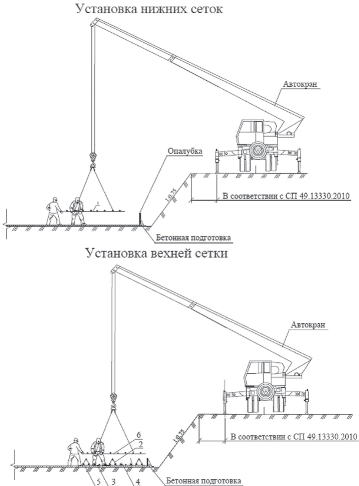
Рисунок М.2 – Схема производства работ по армированию фундаментной плиты краном
