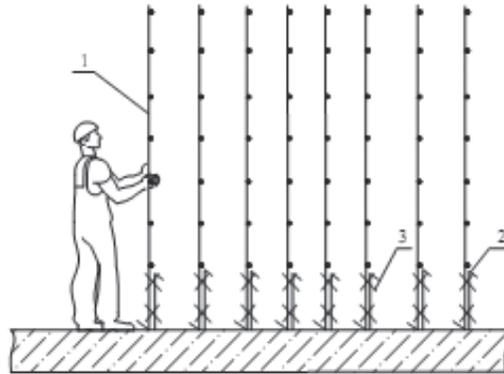
Установка продольных арматурных стержней на высоте до 1,5 м
