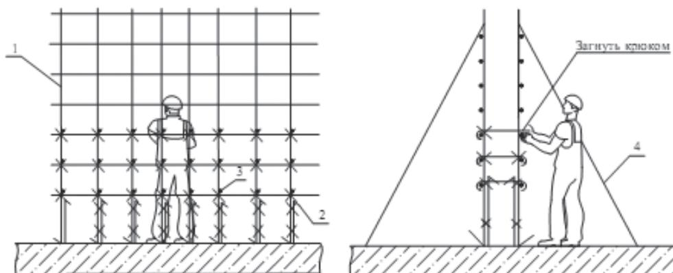
Установка поперечных арматурных стержней на высоте выше 1,5 м
