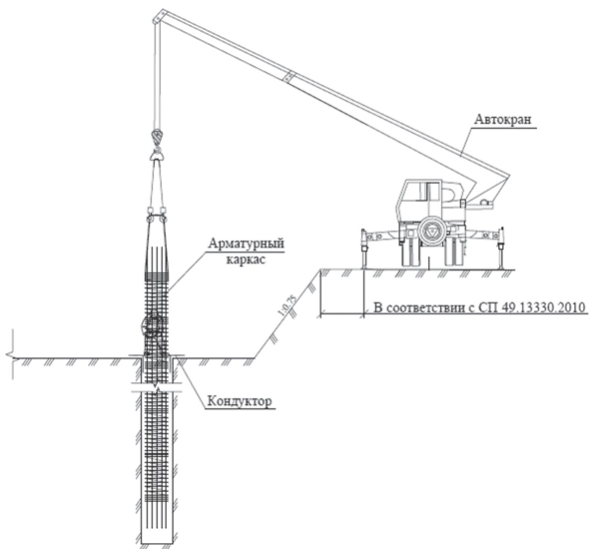
Рисунок М.10 – Схема производства работ по армированию буронабивных свай
