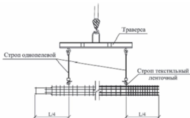
Рисунок Н.5 – Схема строповки объемных каркасов колонн при складировании
