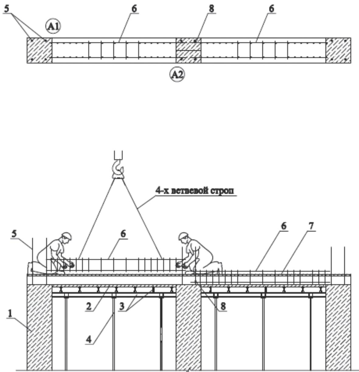
1 – колонна; 2 - опалубка балки; 3 – балка опалубки; 4 – телескопическая стойка;
