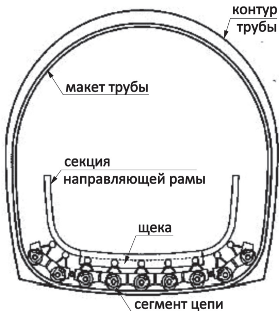
Рисунок 7 – Первый этап сборки навивочной машины
