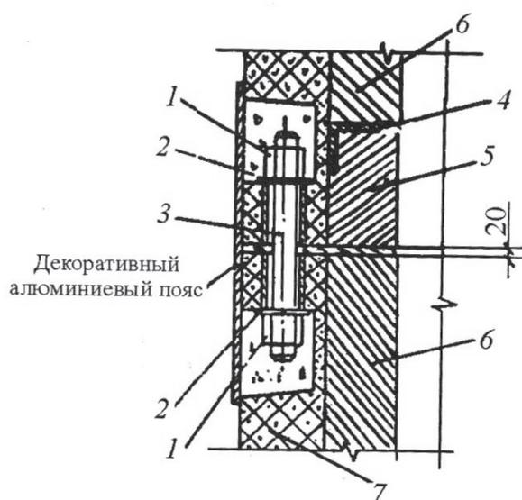
1 – гайка; 2 – шайба; 3 – шпилька; 4 – уголок, приваренный к закладной детали царги;
