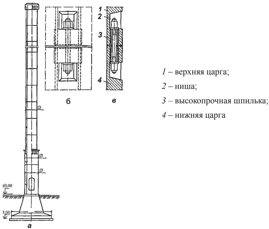
а – общий вид; б, в – узлы крепления
