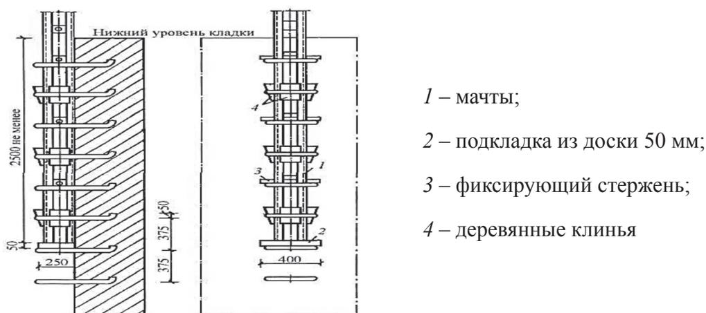
Рисунок 13 – Крепление мачты крана-укосины в скобах
