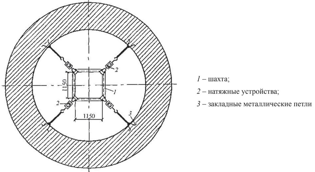
Рисунок Б.29 – Расположение натяжных устройств и скоб для крепления шахты подъемника
