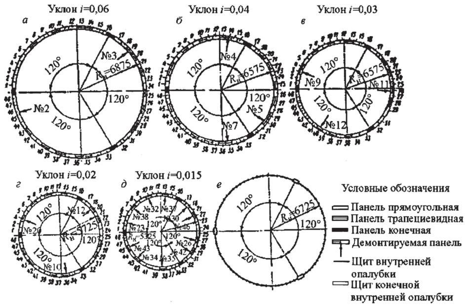
Рисунок Б.27 – Монтажные схемы наружной и внутренней опалубки для возведения ствола трубы высотой 150 м
