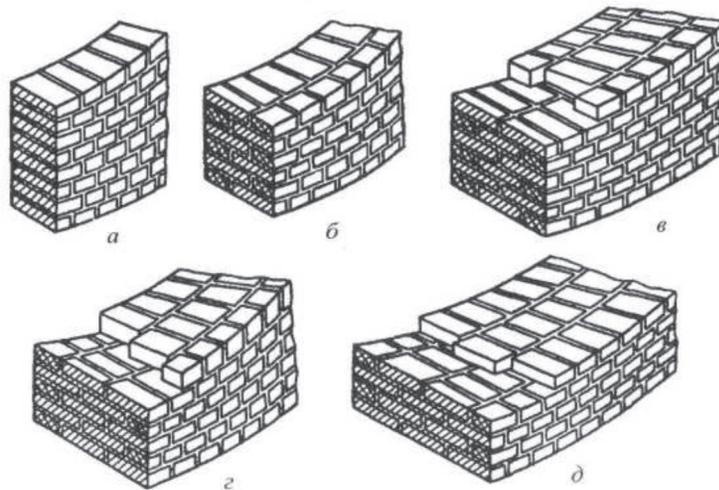
*а* – толщиной в один кирпич; *б* – полтора кирпича; *в* – два кирпича;
