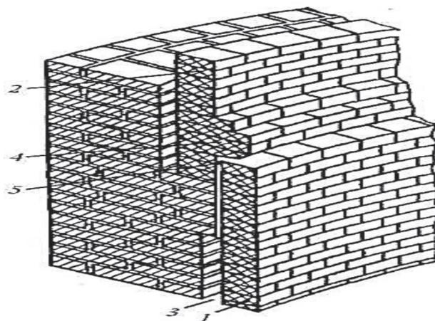
1 – нижнее звено футеровки; 2 – верхнее звено футеровки; 3 – воздушный зазор;
