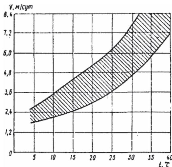
Рисунок 17 – График зависимости скорости подъема скользящей опалубки от температуры наружного воздуха
