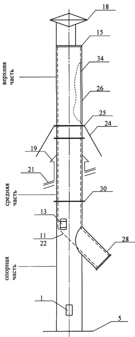
Рисунок Б.7 – Труба над котельной с растяжками
