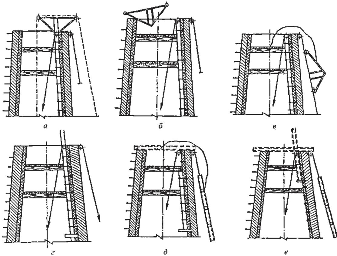
*a* – спуск мачты до уровня касания оголовка обреза кладки; *б* – демонтаж оголовка;
