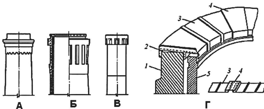
А – кирпичной; Б – монолитной железобетонной;
