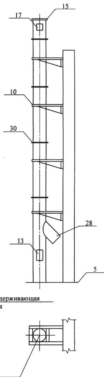
Рисунок Б.9 – Труба одноствольная с кронштейнами
