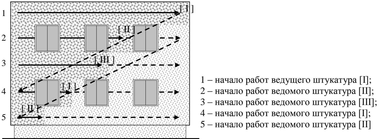
Рисунок 7 – Горизонтально-нисходящая схема устройства
