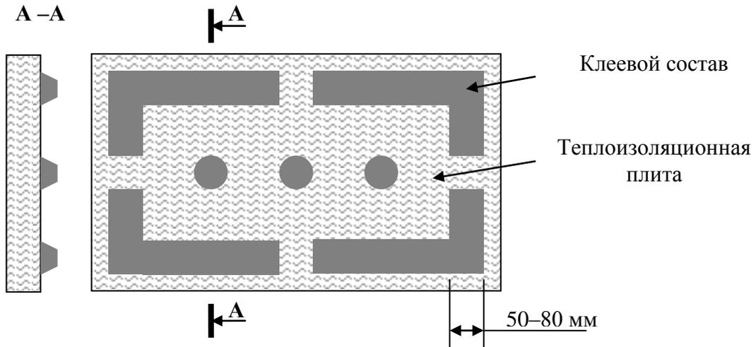
Рисунок 2 – Схема примера нанесения клеевого состава на теплоизоляционную плиту
