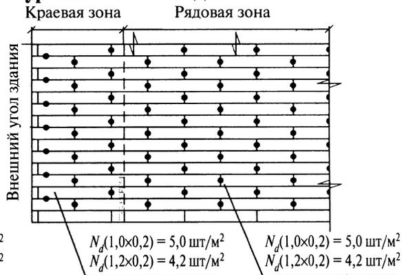
Рисунок 4 – Схемы установки тарельчатых дюбелей
