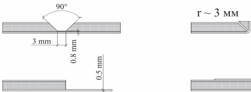
Рисунок 6 – Виды фрезеровок
