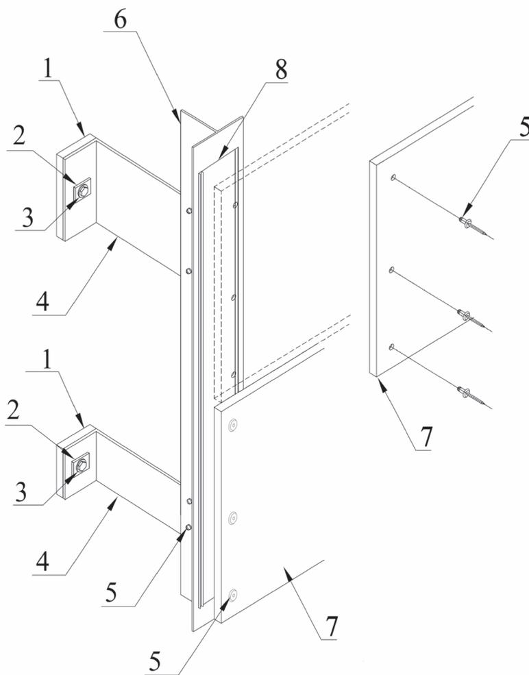
1 – терморазрыв; 2 – шайба; 3 – анкер; 4 – кронштейн; 5 – заклепка вытяжная (винт);
