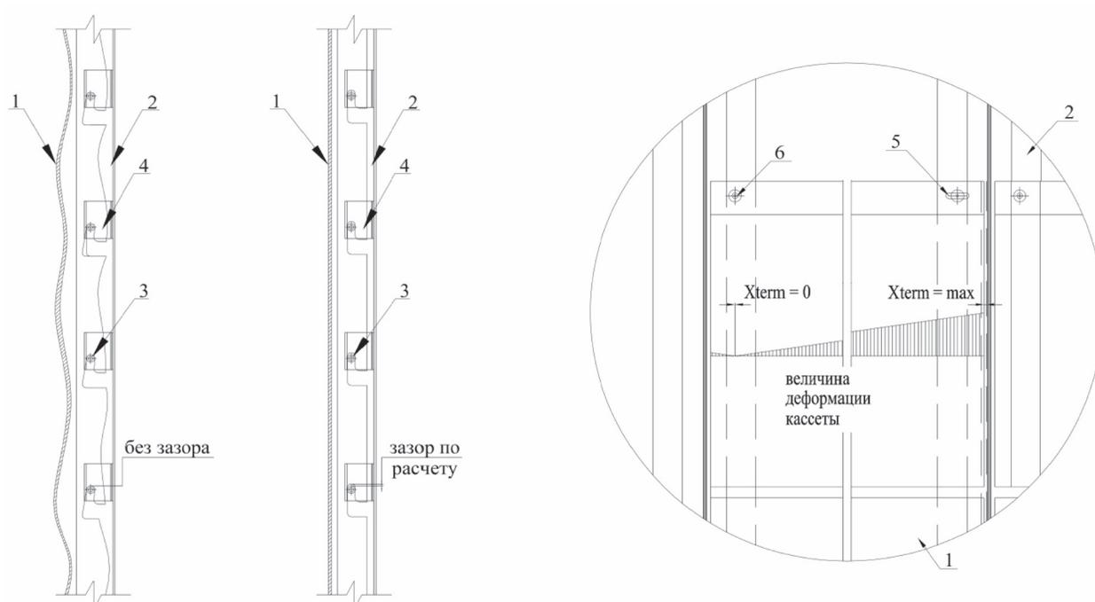
1 – облицовочная кассета; 2 – направляющая; 3 – фиксирующий элемент; 4 – проушина;
