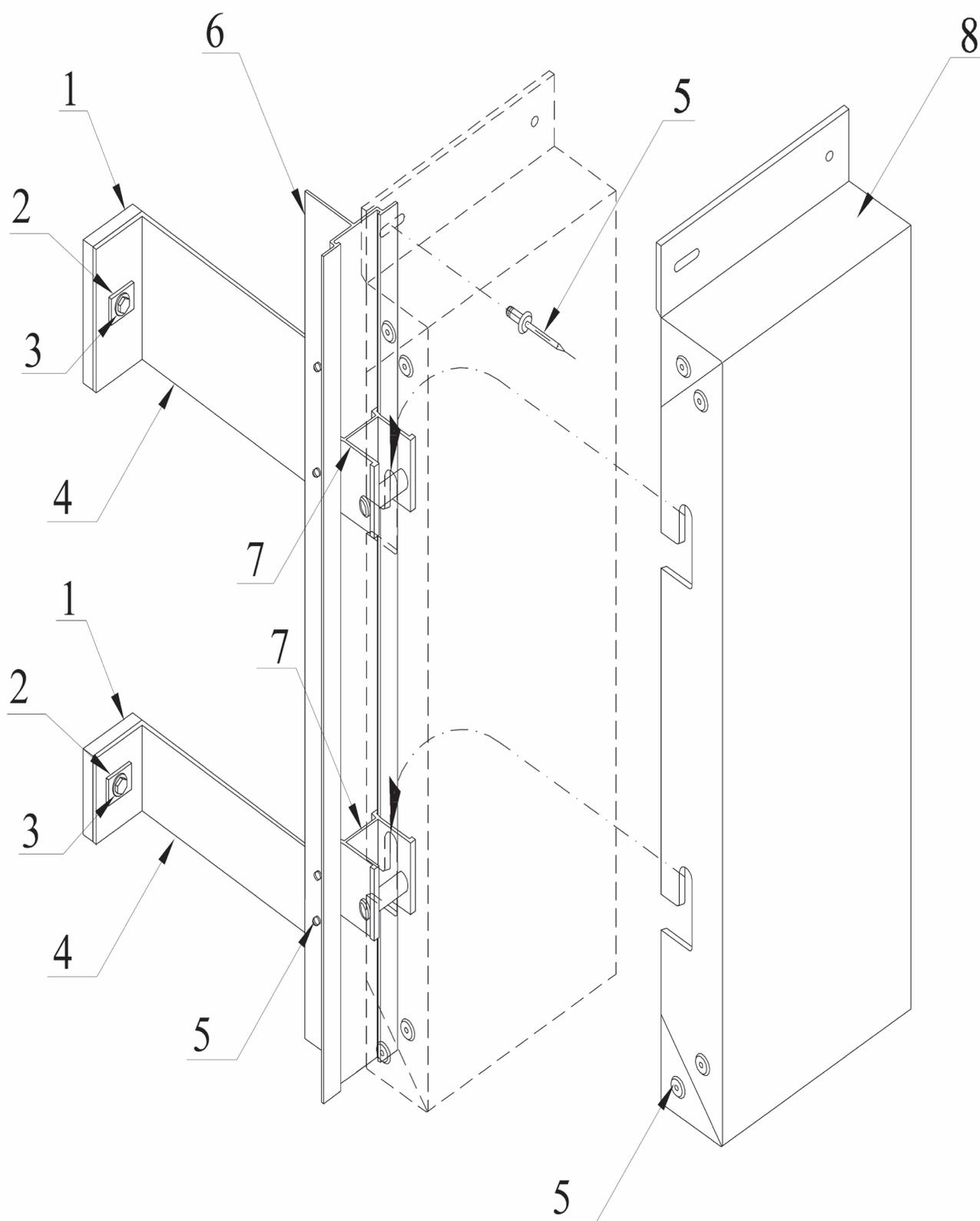
1 – терморазрыв; 2 – шайба; 3 – анкер; 4 – кронштейн; 5 – заклепка вытяжная;
