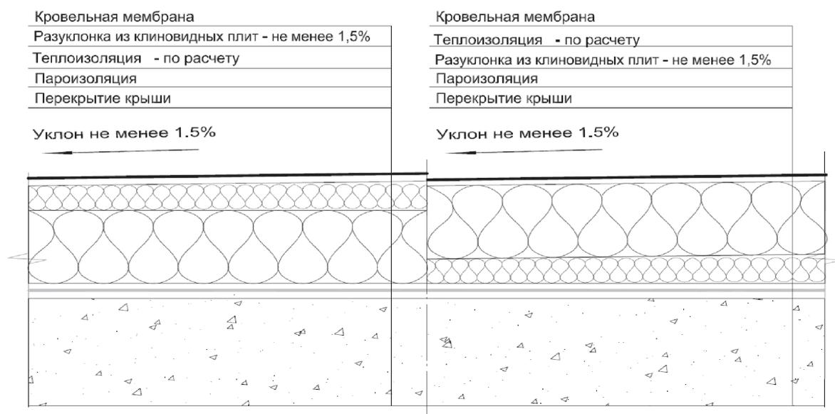
Рисунок 2 – Варианты уклонообразующего слоя из ГМ
