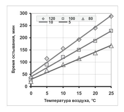
Рисунок В.2 – Время остывания холодной асфальтобетонной смеси до температуры 25 °C (в зависимости от температуры выпуска смеси из асфальтосмесителя)
