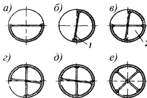
*a–e* – положения печи при поворотах; 1 – основное (первое) крепление распорами; 2 – дополнительное (второе) крепление распорами
