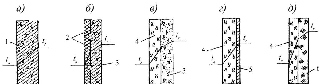
*a* – однослойная; *б* – с теплоизоляционными вкладышам; *в*, *з*, *д* – двухслойная; *1* – однослойная футеровка; *2* – плитная теплоизоляция; *3* – слой легкого жаростойкого бетона; *4* – слой теплоизоляционного материала; *5* – защитный слой тяжелого жаростойкого бетона; *6* – слой волокнистого огнеупорного материала
