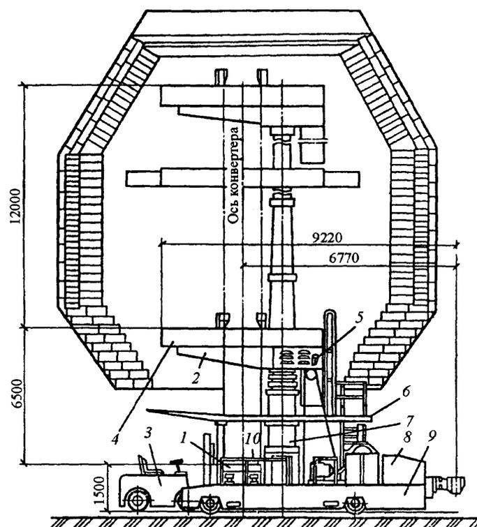
1 – площадка подъема материалов; 2 – упорная консоль; 3 – автопогрузчик; 4 – рабочая площадка; 5 – гидропривод; 6 – козырек; 7 – гидроцилиндр; 8 – двигатель; 9 – тележка; 10 – подъемник
