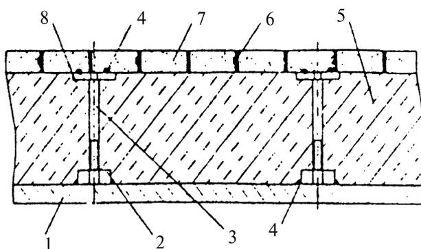
1 – стенка реактора (регенератора, транспортной линии); 2 – гайка; 3 – стойка; 4 – сварка; 5 – теплоизоляционный бетон; 6 – панцирная сетка; 7 – эрозийно-стойкий слой; 8 – шайба
