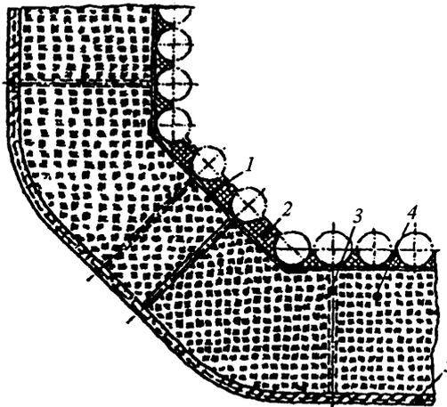
1 – металлический лист; 2 – хромитовая масса; 3 – штырь с шайбой; 4 – теплоизоляционный слой; 5 – штукатурка, армированная сеткой
