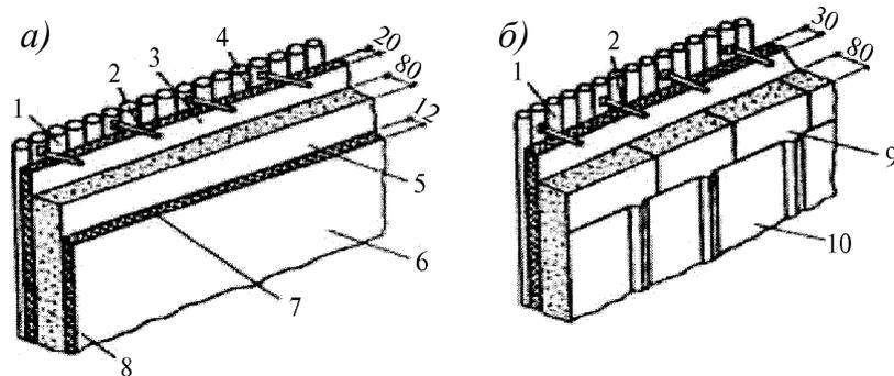
*а* – с наружной обмазкой; *б* – с облицовочным листом; 1 – трубы экрана; 2 – анкерные штыри; 3 – жаростойкий бетон на сетке; 4 – слой крафт-бумаги; 5 – слой стеклоткани; 6 – поверхность обмазки; 7 – обмазка; 8 – минераловатные маты; 9 – минераловатные плиты; 10 – облицовочный лист
