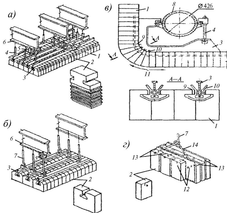
*a* – из рифленого кирпича; *б* – из гладкого кирпича; *в* – набор криволинейной части; *г* – магнетитохромитовый; *1* – вкладыш; *2* – кирпич; *3* – жароупорные балочки; *4* – болт; *5* – скоба; *6* – балка; *7* – тяга; *8* – водоохлаждаемая балка; *9* – приливы; *10* – литая деталь; *11* – направление набора свода; *12* – стальной стержень; *13* – стальная прокладка; *14* – подвески
