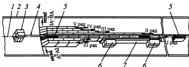
1 – ось печи; 2 – корпус печи; 3 – закрепление «зачалки» (шнура); 4 – шнур; 5 – маячные кирпичи; 6 – кирпич для крепления упорного бруса; 7 – упорный брус
