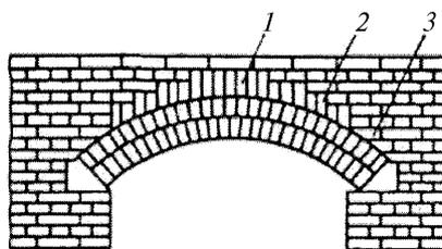
1 – на торец; 2 – на ребро; 3 – на плашку
