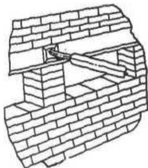
Рисунок 56 – Временное крепление замка футеровки маяками из кирпича
