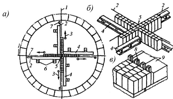
*a* – схема закладки креста; *б* – деталь закладки креста; *в* – закрепление клиньями крайних изделий; 1 – ось креста; 2 – шнур; 3 – направление движения огнеупорщиков; 4 – брусья; 5 – лещадное изделие; 6 – блоки, удерживающие брусья; 7 – причальные изделия; 8 – деревянные клинья; 9 – углеродистые блоки
