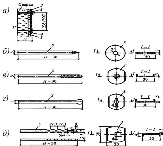
*a* – схема анкерного крепления; *б* – анкер с привариваемой шайбой; *в* – с винтовой шайбой; *г* – с поворотной шайбой; *д* – с многопозиционной шайбой; *1* – кожух; *2* – анкер; *3* – шайба; *4, 5* – слои волокнистой футеровки
