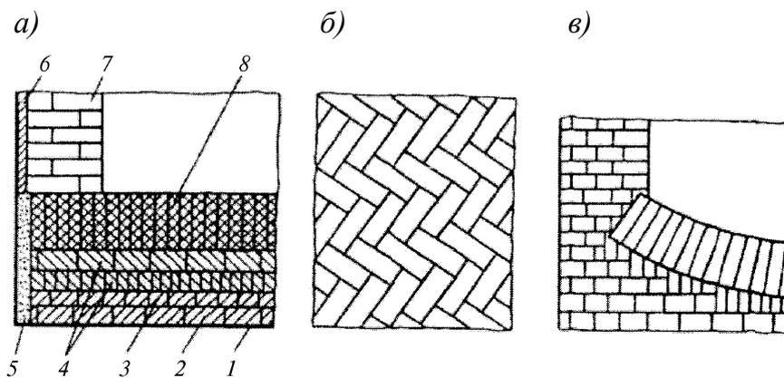
*a* – многослойная подина; *б* – «в елочку»; *в* – обратным сводом; 1 – кожух; 2 – легкий кирпич на ребро; 3 – огнеупорный кирпич на плашку; 4 – огнеупорный кирпич на ребро; 5 – температурный шов; 6 – асбест листовой; 7 – стена; 8 – огнеупорный кирпич на торец
