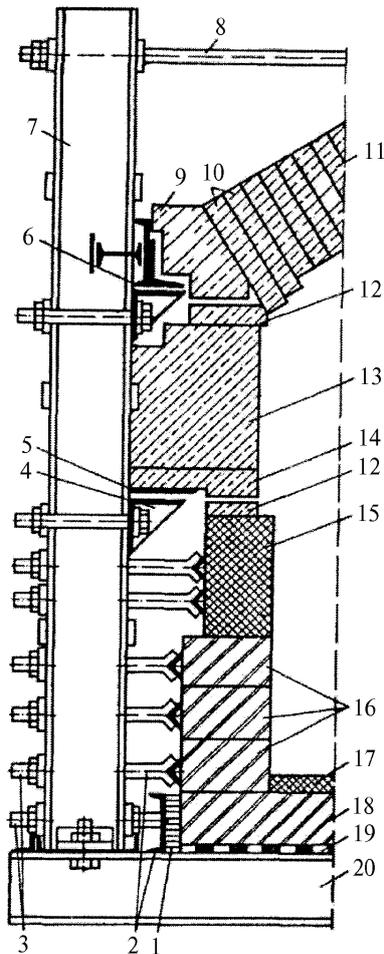
1 – разделка шамотным кирпичом; 2 – пружинные устройства; 3 – прижимные болты; 4 – кронштейн; 5 – лафет; 6 – подпятная балка; 7 – колонна; 8 – тяга; 9 – пяты; 10 – защитные изделия пяты; 11 – главный свод; 12 – подклинок; 13 – подвесная стена; 14 – «зуб»; 15, 16 – блоки окружки; 17 – плитка; 18 – дно; 19 – опорные полосы; 20 – поперечная балка
