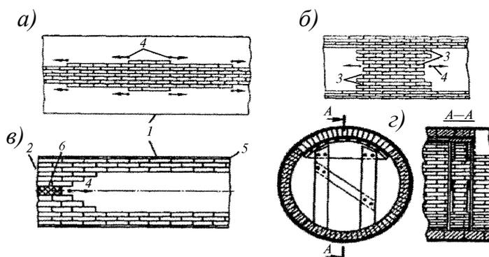
*a* – убегающей штрабой от центра хватки; *б, в* – забивка замка штрабой (без опалубки); *г* – забивка с опалубкой; 1 – кожух; 2 – торец; 3 – штраба; 4 – огнеупорщики; 5 – коалиновый картон; б – замок (стрелками показано направление кладки)
