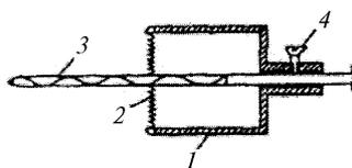
1 – колпачок; 2 – фреза на колпачке; 3 – сверло дрели; 4 – установочный винт
