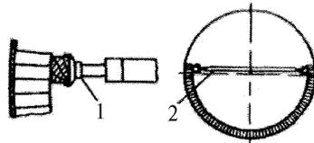
1 – установка крепления у края футеровки; 2 – установка первого ряда распор
