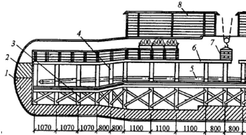
1 – уровень центральной оси; 2 – уровень начала сползания изделий; 3 – стоечные леса; 4 – стойки опалубки; 5 – конвейер; 6 – прогоны опалубки; 7 – пакет изделий; 8 – ограждение площадки
