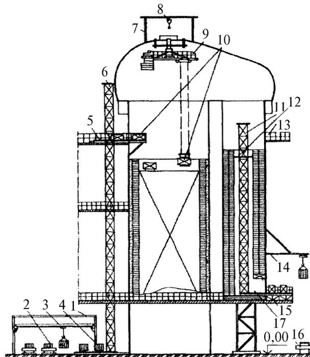
1 – здание тепляка; 2 – платформа; 3 – однобалочные краны; 4 – роликовые конвейеры; 5 – консольный мостик; 6 – подъемник; 7 – П-образные стойки; 8 – электроталь; 9 – МПО-2; 10 – пакет с изделиями; 11 – шахтный подъемник; 12 – рабочая площадка; 13 – технологическая площадка; 14 – консольный монорельс с электроталью; 15 – роликовый конвейер; 16 – автомашина; 17 – проем керамической горелки
