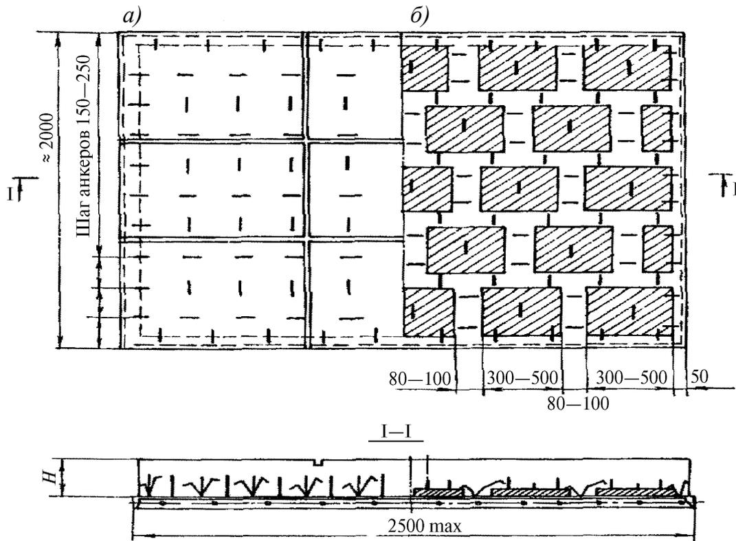
*a* – однослойная; *б* – с теплоизоляционными вкладышами
