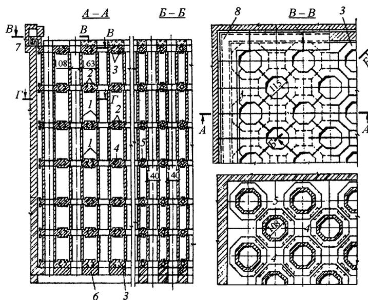
1 – керамические трубки; 2 – промежуточные звёздочки; 3 – нижние и верхние звёздочки; 4 – керамические вставки; 5 – уплотнительные цилиндры; 6 – нижние опорные изделия; 7 – песочный затвор; 8 – перекрывающие плиты
