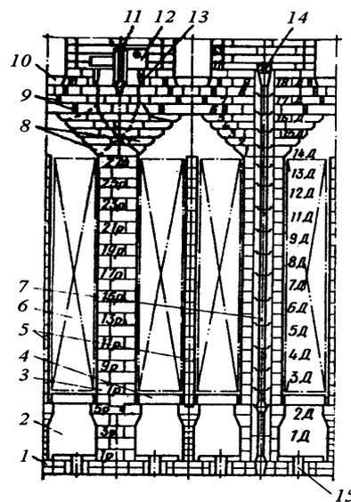
1 – выстилка; 2 – подовый канал; 3 – стена регенератора (дюзовый простенок); 4 – колосниковая решётка; 5 – разделительная перегородка (печной простенок), 6 – зона с насадкой; 7 – газоподводящий (дюзовый канал); 8 – косой ход; 9 – температурный шов, 10 – подовый кирпич; 11 – рассекатель; 12 – разделительный кирпич; 13 – регистр (банан); 14 – горелка, 15 – шов скольжения
