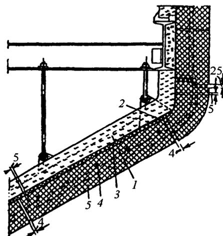
1 – диатомитовый кирпич; 2 – фанера толщиной 4 мм; 3 – уплотнительная огнестойкая обмазка; 4 – проволочная арматура диаметром 4 мм; 5 – огнеупорный шамотный бетон
