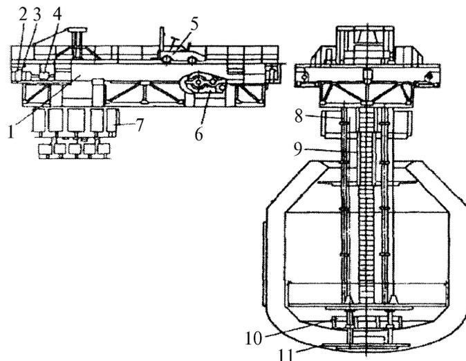
1 – мост крана; 2 – механизм передвижения; 3 – редуктор; 4 – подъемник материалов; 5 – погрузчик; 6 – лебедка; 7 – откидные помосты; 8 – телескопические направляющие; 9 – лестница; 10 – рабочая площадка; 11 – нижняя площадка
