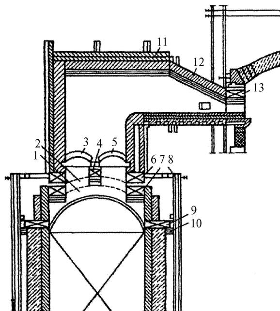
1, 2 – первый и второй окаты сводов регенераторов; 3, 5 – арки шиберов; 4 – распорная арка; 6, 7 – поперечные арки; 8 – стойка каркаса; 9, 10 – арки над зеркалами; 11 – прямой свод; 12 – понурый свод; 13 – влет
