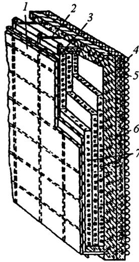
1 – уплотнительная газонепроницаемая обмазка; 2 – крепление проволочного каркаса;
