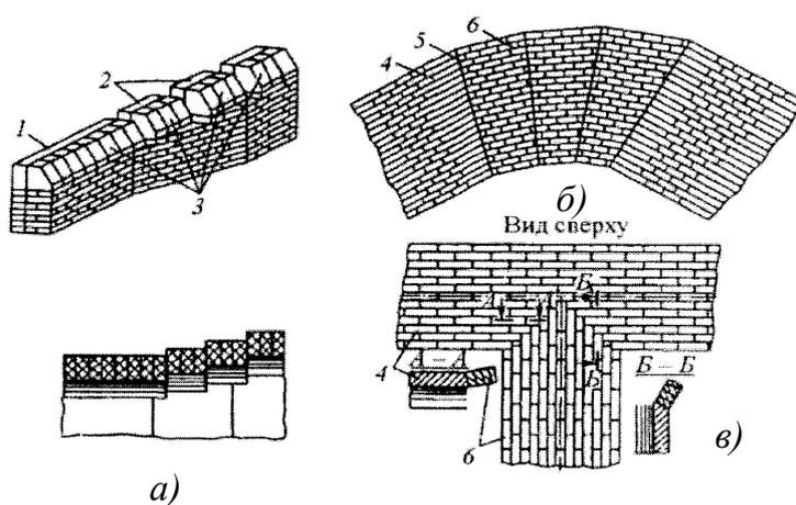
*a* – ступенчатый с изменяющимся пролетом; *б* – с изменяющимся направлением; *в* – пересечение сводов под прямым углом; *1* – подпятовая балка; *2* – разделка пят; *3* – пяты; *4* – свод одного направления; *5* – отрезной шов; *6* – свод второго направления
