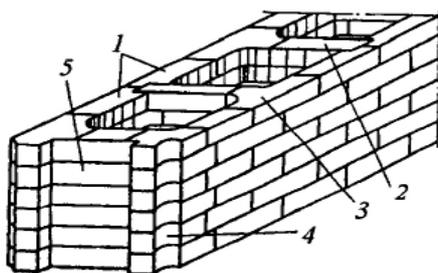
1 – ложковый стеновой кирпич; 2 – брусок (распорочный кирпич); 3 – гитарковый стеновой кирпич; 4 – заплечик головки; 5 – ниша для изоляции головки фасада
