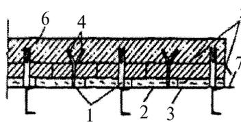
1 – приваренные пластинчатые анкеры; 2 – слой изоляции; 3 – слой высокотемпературной изоляции; 4 – анкерные «усы»; 5 – водонепроницаемый материал; 6 – слой жаростойкого бетона; 7 – кожух
