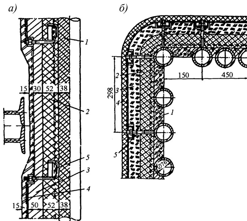
*a* – натрубная облегчённая бетонная обмуровка; *б* – бетонная облегчённая обмуровка угла топки; 1 – хромитовая шамотная масса; 2 – легковесный теплоизоляционный бетон; 3 – теплоизоляционные плиты; 4 – газонепроницаемая штукатурка; 5 – анкеры
