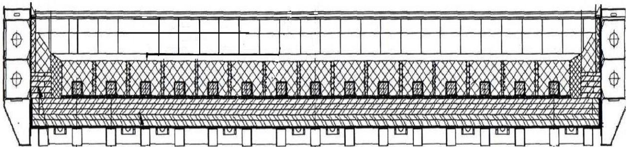
Рисунок Ж.10 – Схема катодной футеровки (продольный разрез)
