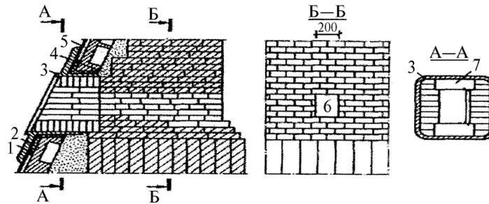
1 – кожух; 2 – вертикальный холодильник; 3 – рама летки; 4 – углеродистая масса; 5 – зазор; 6 – лёточное отверстие; 7 – изделие перекрытия канала
