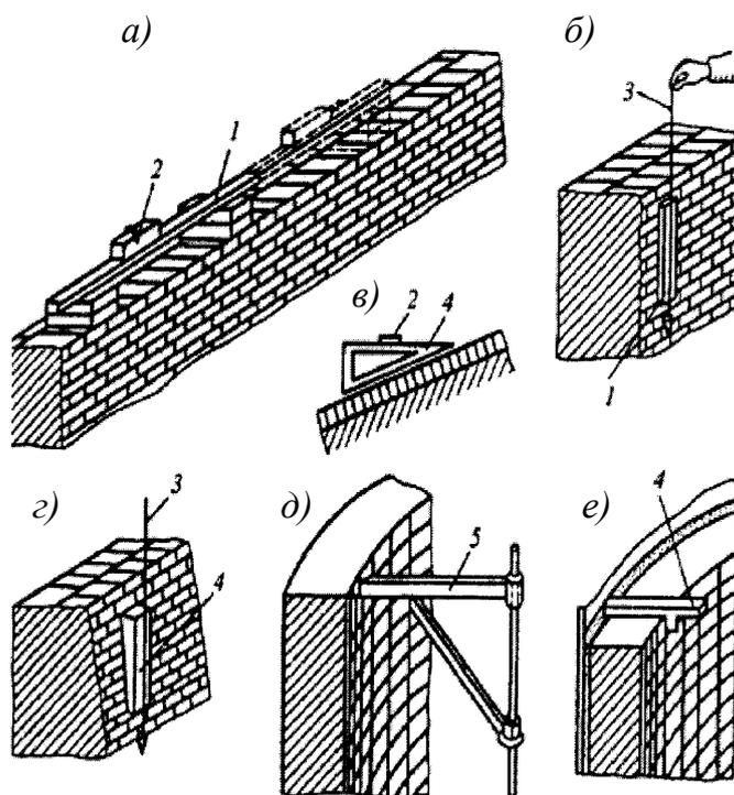
*a* – горизонтальности; *б* – вертикальности; *в*, *г* – наклона; *д* – радиуса; *е* – толщины;
