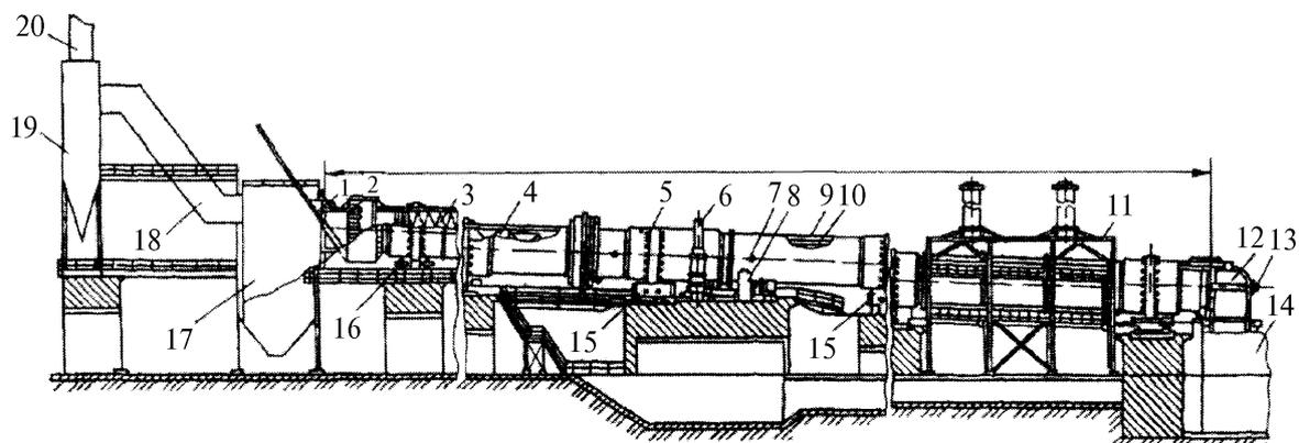
1 – течка для подачи шлама; 2 – фильтр-подогреватель; 3 – цепная завеса; 4 – теплообменник; 5 – бандаж; 6 – венцовая шестерня; 7 – пробоотборные лючки; 8 – привод печи; 9 – корпус печи; 10 – огнеупорная футеровка; 11 – устройство для охлаждения корпуса печи в зоне спекания; 12 – головка печи; 13 – горелка; 14 – холодильник; 15, 16 – роликовые опоры; 17 – пылевая камера; 18, 20 – газоходы; 19 – фильтр
