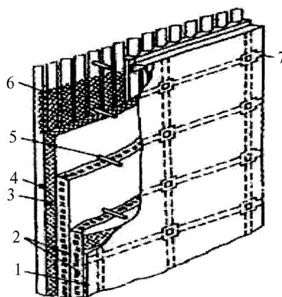
1 — газонепроницаемая обмазка; 2 — теплоизоляционные плиты; 3 — шамотный бетон;
