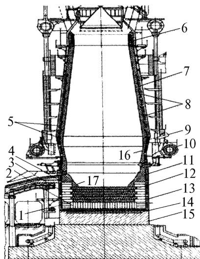
1 – углеродистая масса; 2 – графитированные вертикальные блоки; 3 – углеродистые блоки; 4 – углеродистая часть горна; 5 – засыпка; 6 – защитные сегменты колошника; 7 – шахта; 8,13 – периферийные холодильники; 9 – распар; 10 – кольцевой воздухопровод; 12 – алюмосиликатная часть лещади; 14 – подлещадные холодильники; 15 – пень; 16 – заплечики; 17 – защитный слой
