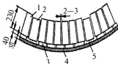
1 – основной кирпич, уложенный на лещадку; 2 – основной кирпич закрепляющего ряда, уложенный на слой раствора; 3 – шамотная лещадка; 4 – корпус печи; 5 – слой раствора под закрепляющим рядом основного кирпича
