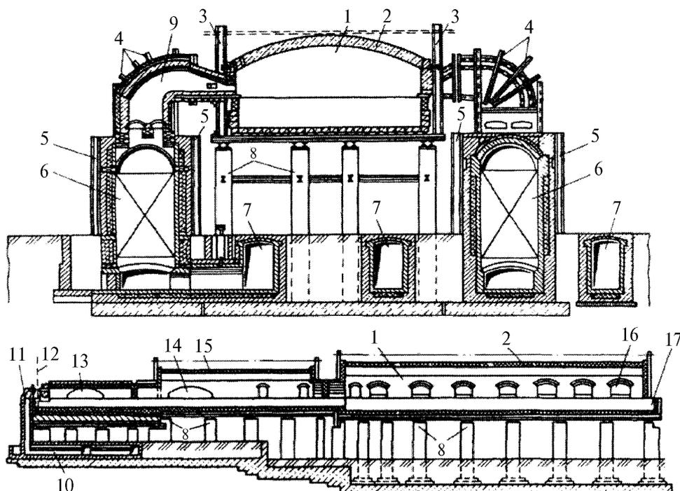
1 – рабочее пространство варочной печи; 2 – главный свод; 3 – каркас верхнего строения; 4 – каркас горелок; 5 – каркас регенераторов; 6 – регенераторная камера; 7 – воздуходымные каналы; 8 – опорные столбы; 9 – горелка; 10 – боров машинного канала; 11 – вертикальный дымовой канал; 12 – ось машины для вытягивания стекла; 13, 14 – малый и большой поперечные каналы; 15 – свод студочной части; 16 – влеты горелок; 17 – засыпной карман
