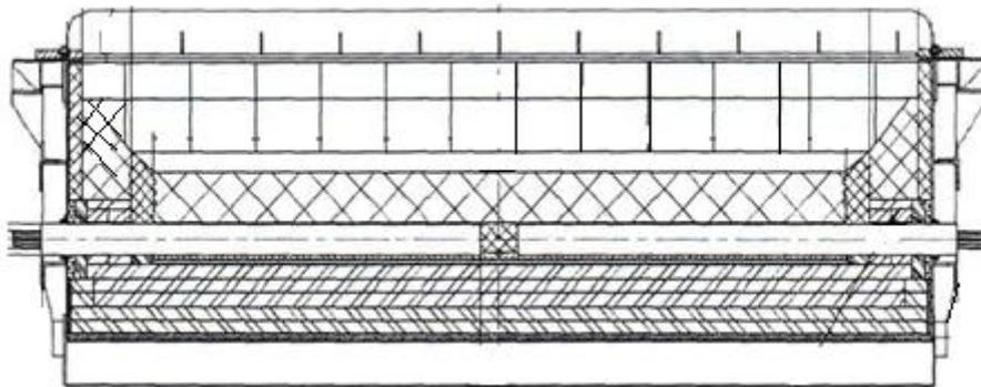
Рисунок Ж.11 – Схема катодной футеровки (поперечный разрез)
