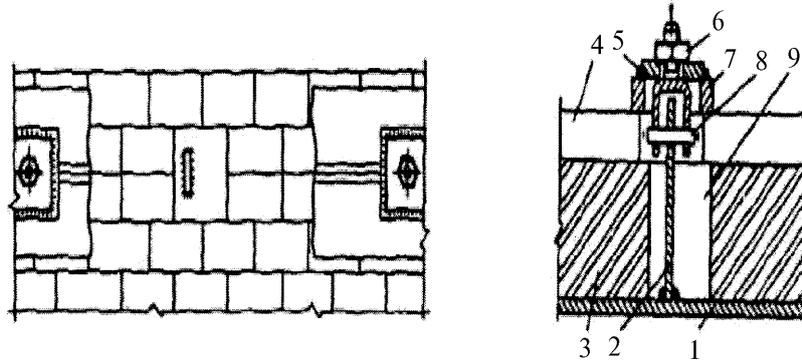
1 — кожух; 2 — пластина; 3 — футеровка; 4 — прижимная доска; 5 — вилочный болт;
