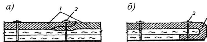
*a* – на плоской поверхности; *б* – на торцевом участке; *1* – соединяемые слои; *2* – анкер
