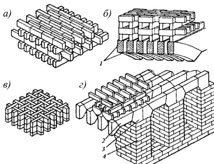
*a, б* – с открытыми каналами; *в* – с закрытыми каналами; *г* – фрагмент поднасадочного устройства; *1* – поднасадочная арка; *2* – распорное изделие; *3* – пята; *4* – поднасадочная стена
