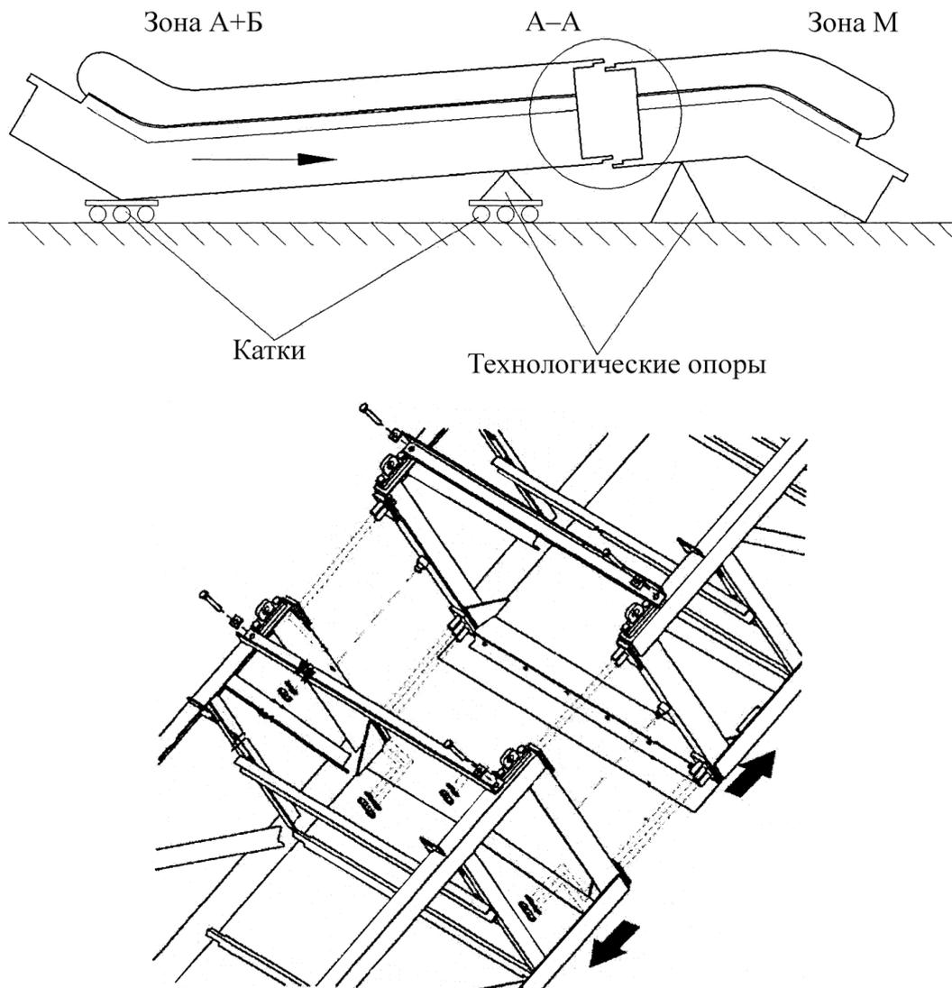
Рисунок 14 – Схема соединения зон М и А+Б
