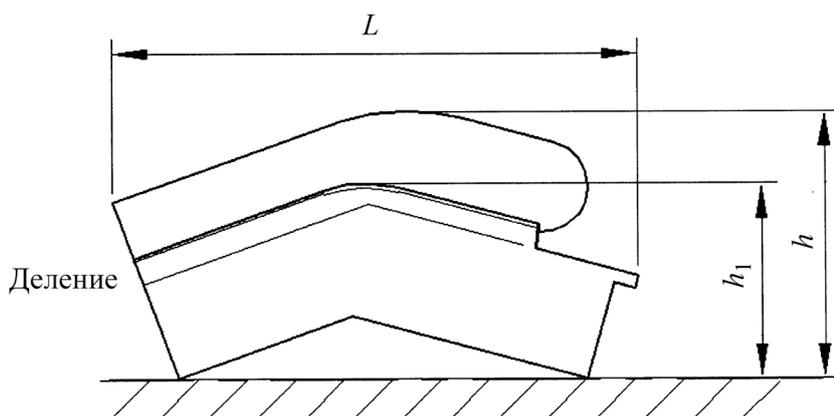
Рисунок 5 – Габаритные размеры зоны М
