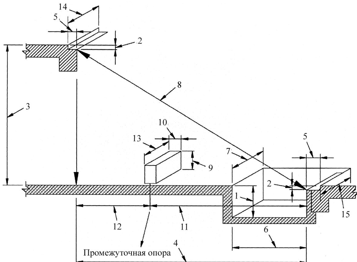
1 – глубина приемка; 2 – глубина кармана по отношению к «чистому» полу; 3 – вертикальный подъем; 4 – опоры «от поверхности до поверхности»; 5 – ширина кармана; 6 – длина приемка; 7 – ширина проема до установки; 8 – расстояние «от поверхности до поверхности»; 9 – высота промежуточной опоры; 10 – ширина промежуточной опоры; 11 – положение промежуточной опоры от нижней стороны; 12 – положение промежуточной опоры от верхней стороны; 13 – длина промежуточной опоры; 14 и 15 – ширина зазора кармана
