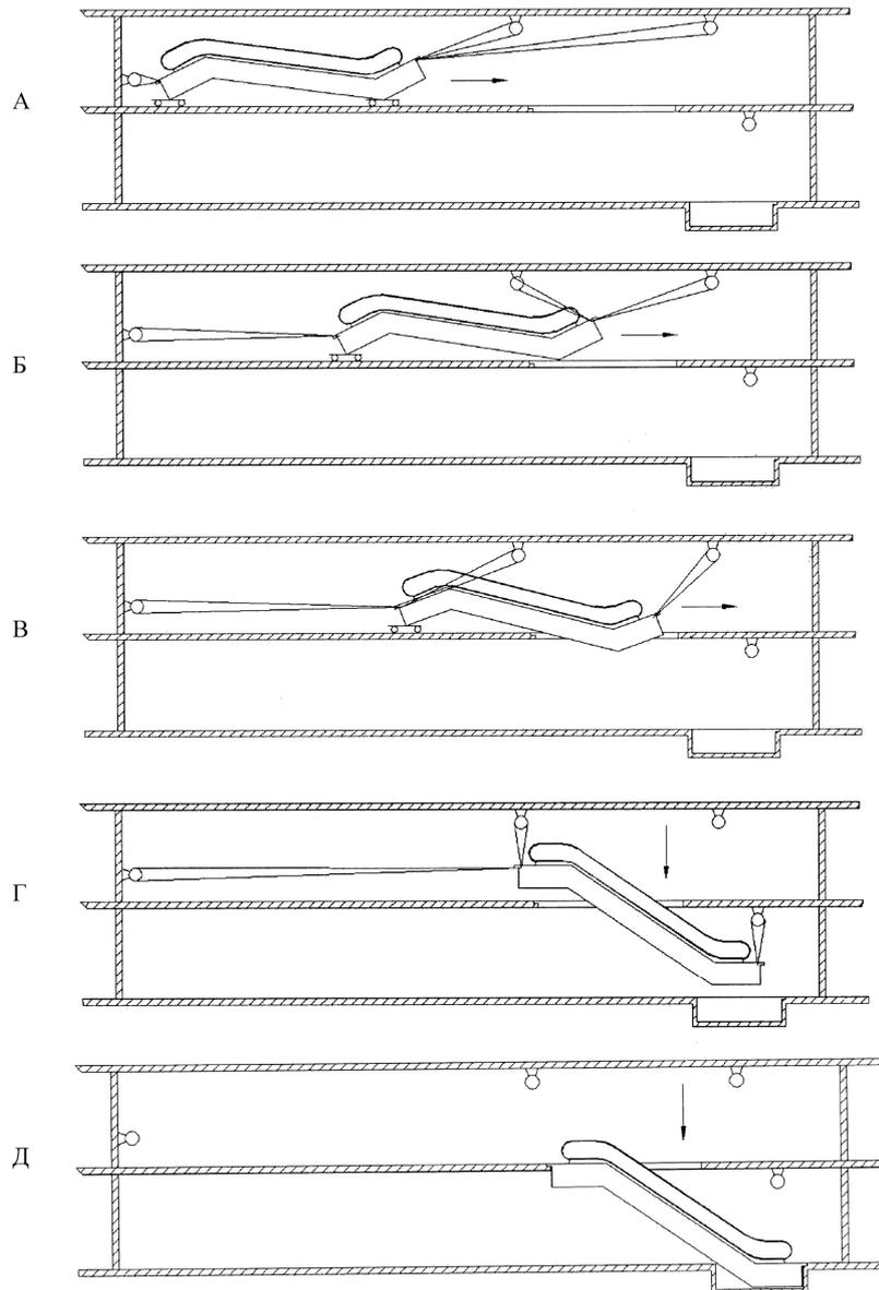
А – начальное положение эскалатора на верхней площадке; Б – подтягивание эскалатора к проему верхней площадки; В – опускание эскалатора в проем верхней площадки;
