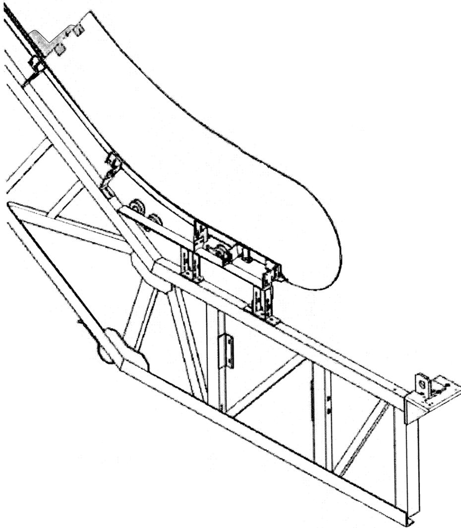
Рисунок 15 – Установка крайней стеклянной панели
