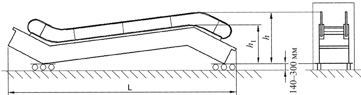
Рисунок 2 – Габаритные размеры эскалатора в сборе
