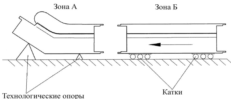
Рисунок 13 – Схема соединения зон А и Б
