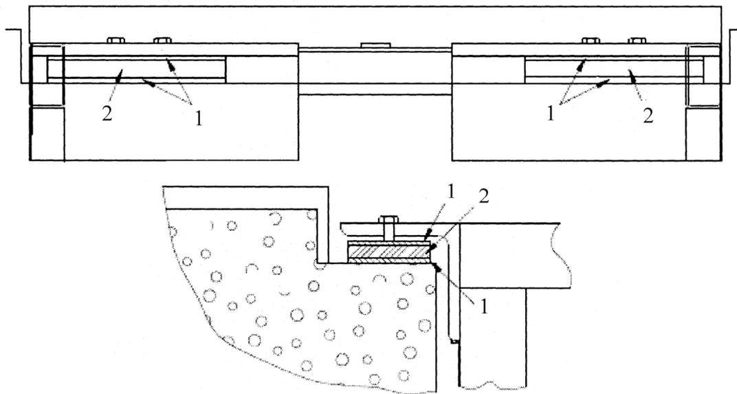
1 – опорная пластина; 2 – резиновый амортизатор
