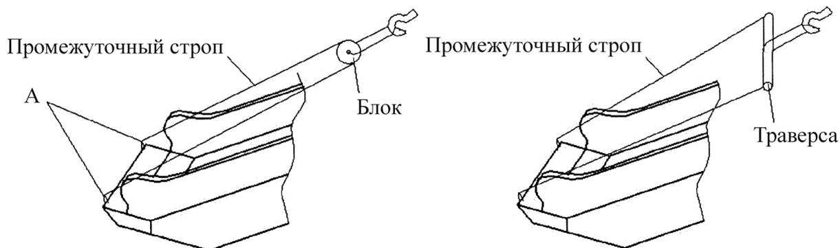
Рисунок 6 – Схемы строповки эскалатора за грузовые скобы
