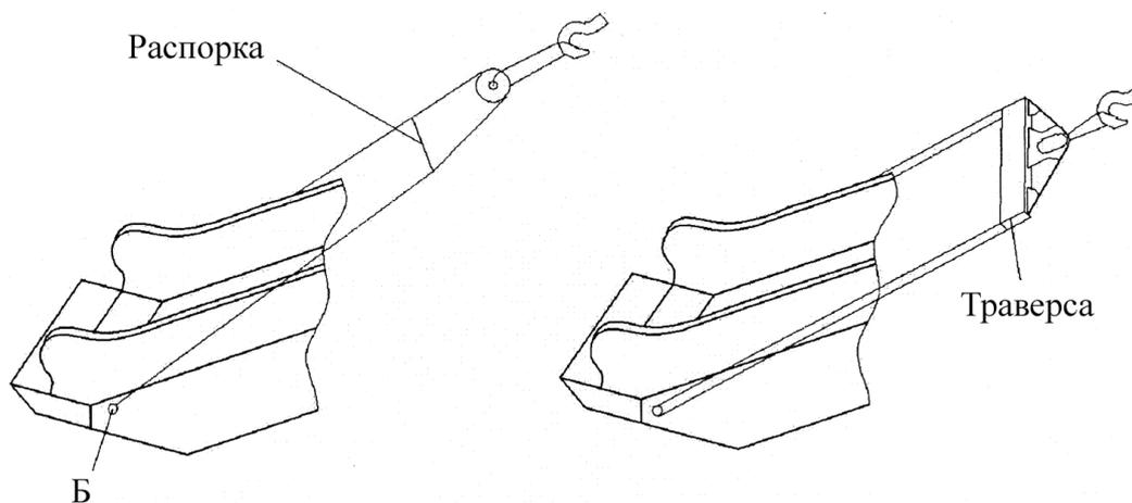
Рисунок 7 – Схемы строповки эскалатора за отверстия в поясах
