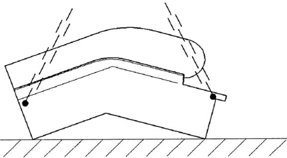
Рисунок 9 – Схема строповки зоны М
