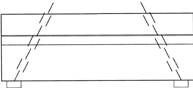
Рисунок 10 – Схема строповки зоны Б
