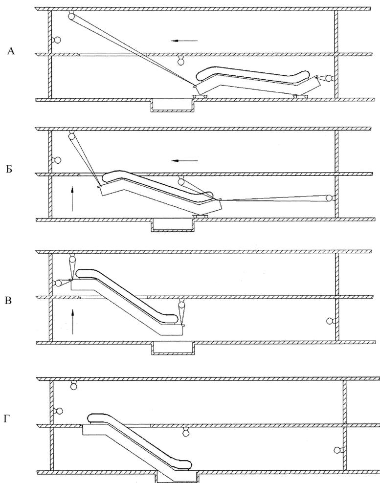
А – начальное положение эскалатора на нижней площадке; Б – подтягивание эскалатора к проему верхней площадки; В – установка нижней части эскалатора над приямком;
