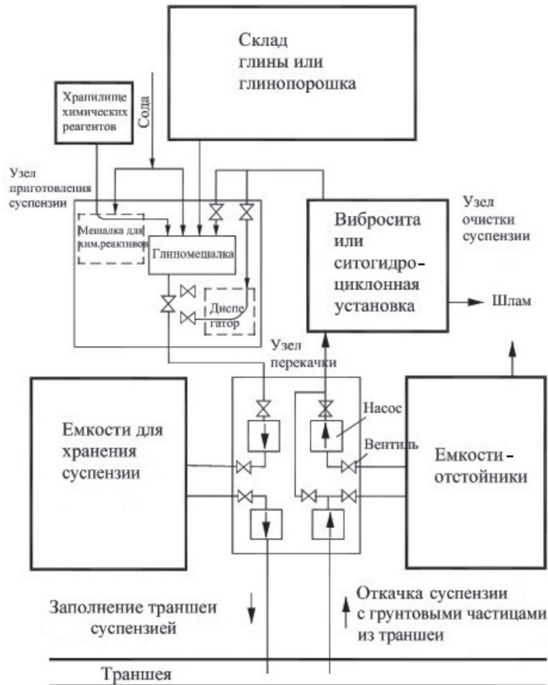
Рисунок 8 – Рекомендуемая схема технологического комплекса для приготовления и очистки суспензии
